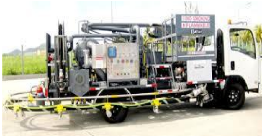
Hình 7. Hệ thống súc rửa tuần hoàn bồn đặt trên xe tải
